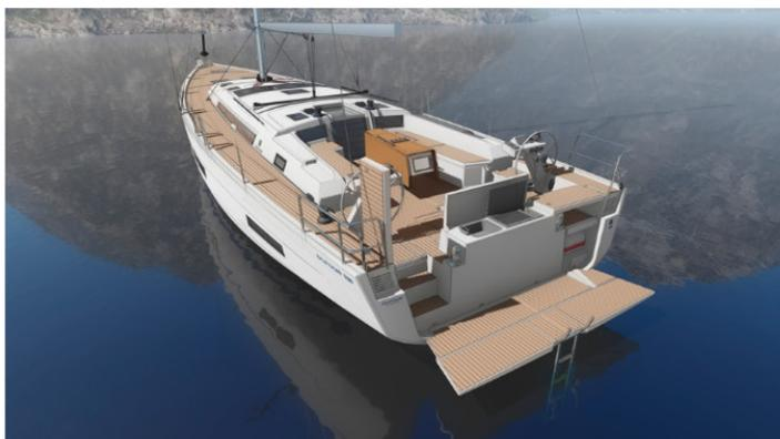
La version « Ocean » s'adresse aux propriétaires souhaitant un plan de manoeuvre traditionnel, avec les manoeuvres de drisses et le chariot de grand-voile sur le roof et les manoeuvres d'écoutes sur les hiloires.
